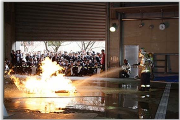
可燃性液体火災の消火実験
