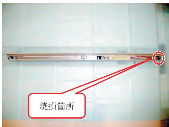
写真3 取り外した照明器具全景
