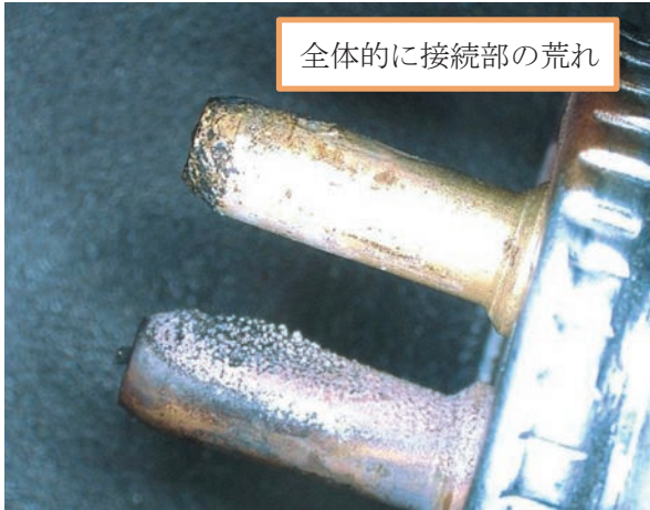
写真8 焼損側の蛍光管口金両面の状況
