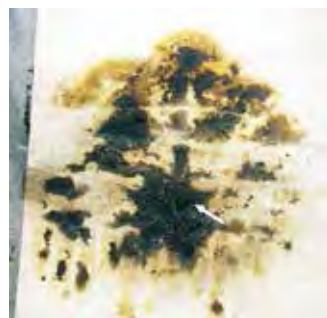
実験Bの床面（コンパネ）の焼き状況
