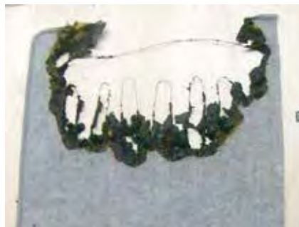
実験Bのカーペットの焼き状況
