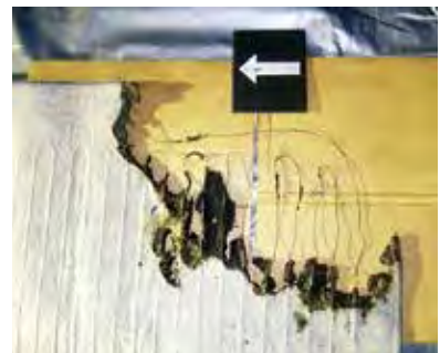
火災現場で焼きしたカーペットの焼き状況
