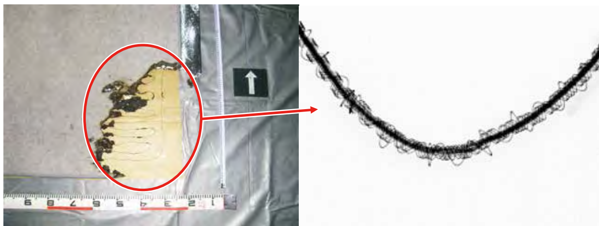
電気カーペットの焼き部分
