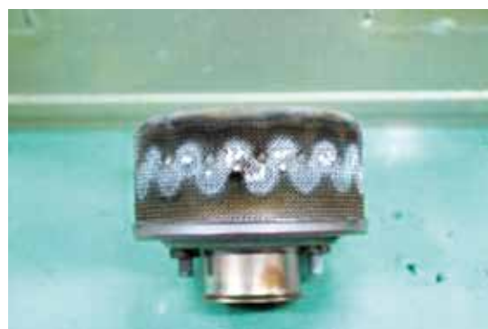
写真6 バーナーヘッドの状況
