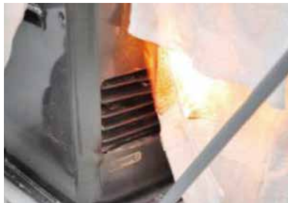
写真12 タオルに着火した状況
