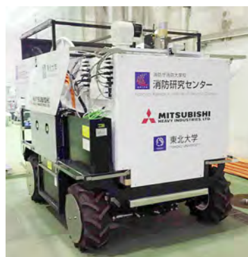
写真4 ホース延長ロボット一次試作機の概観
