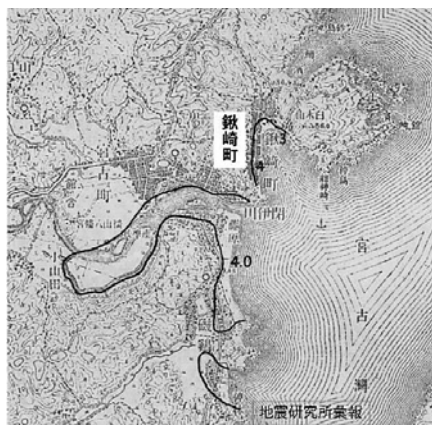
図-2 昭和三陸大津波の鉾ヶ崎津波痕跡 (地震研究所、文献5)
