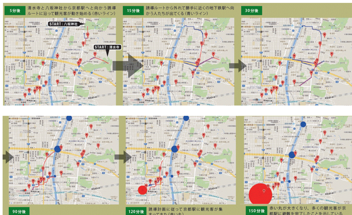
図3 避難誘導を行わない場合の計算機シミュレーションの例
