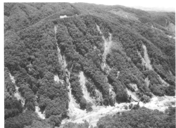
写真3 壮齢の雑木林斜面での崩壊等の集中発生 (2010年7月18日撮影)
