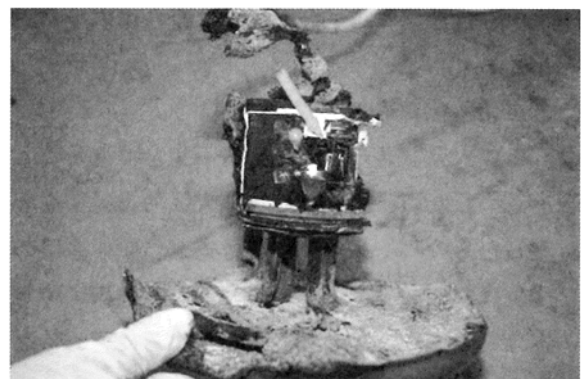
写真：リレースイッチ部（矢印）
