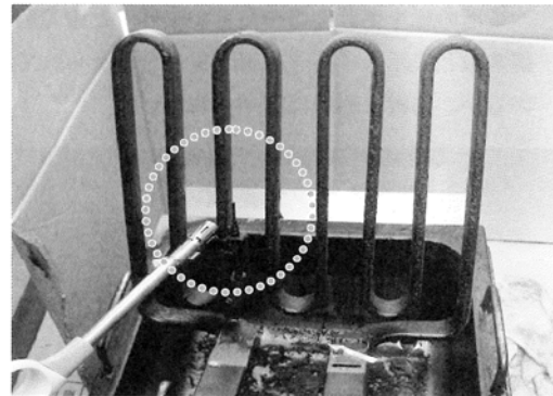
【異常過熱防止装置をバーナー式点火棒で加熱】
