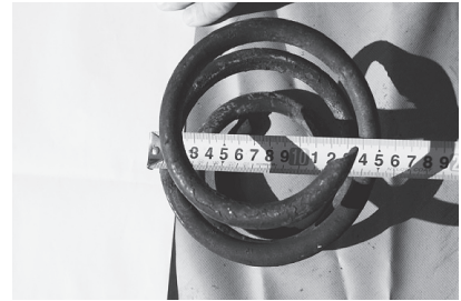
写真3 スプリング欠損状況
