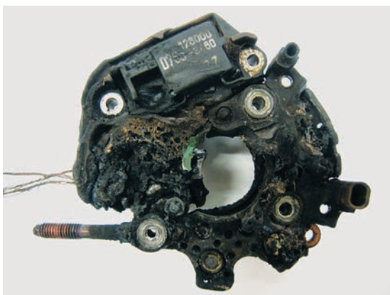
別添7 オルタネーターの状況
