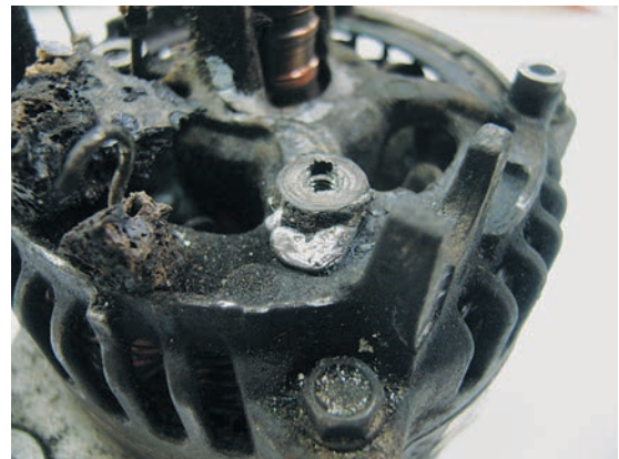
別添9 オルタネーターの状況
