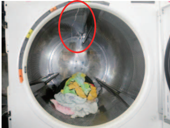
写真9 ドラム内中央の熱電対
