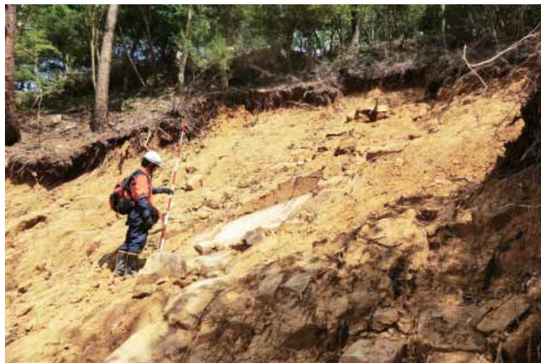
写真7 流紋岩凝灰岩の崩壊。風化土壌とやや風化した基岩の境界が崩壊源頭部付近で見られる。
