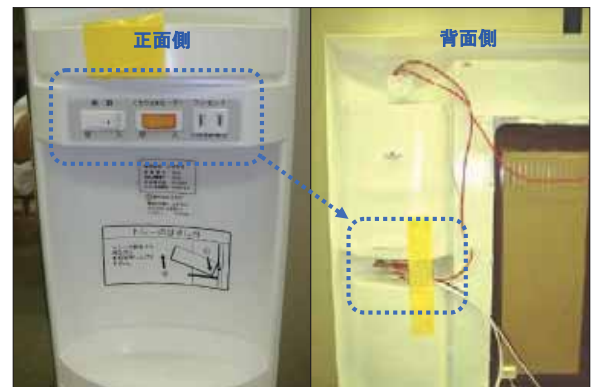
写真 スイッチ部裏側の配線収納スペース(同型品)
