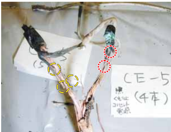
写真 断線箇所
