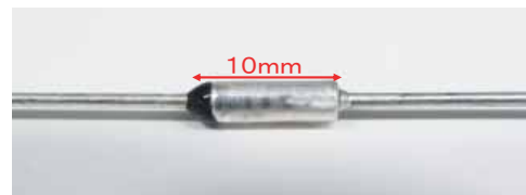
同型品は公称作動温度109℃、定格電流15アンペア
