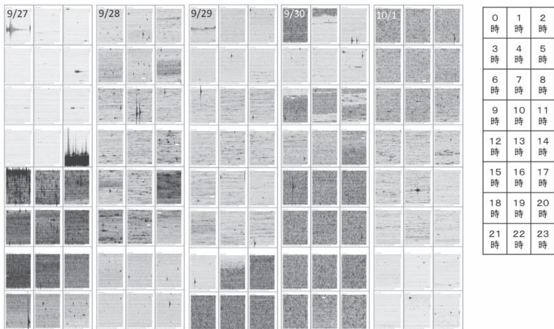
図2 噴火した9月27日から10月1日にかけての火山性微動の記録。山頂南東側3kmの位置にある気象庁の地震計記録。9月27日11時台から噴火に伴う微動が記録されている。火山性微動の震幅は徐々に減衰していったが、29日の19時頃から急に震幅が大きくなり、9月30日の深夜にかけて大きな震幅が記録されている。10月1日の未明から徐々に震幅が小さくなっていることが分かる。
