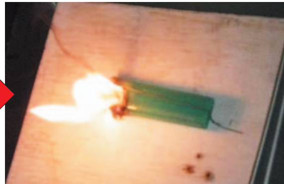
写真No.7 着火約2分40秒後 本体ケース内の燃料ガスが噴出
