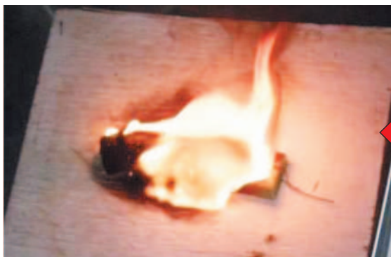
写真No.9 着火約9分30秒後 ガスライター全体が燃える
