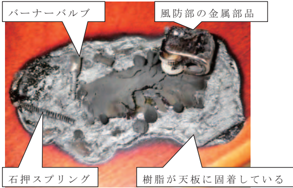
写真No.2 焼損箇所（下駄箱天板）の状況
