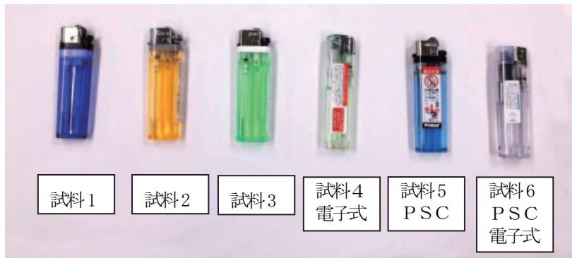
写真No.12 成分・熱分析をするフリント式ガスライター及び電子式ガスライター
