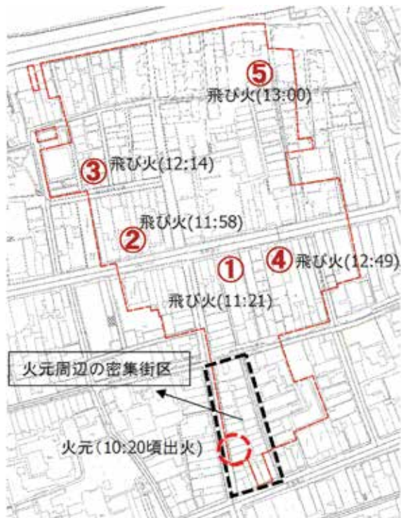
図1 糸魚川市火災の延焼範囲図 (糸魚川市消防本部作成による図。上側が北)
