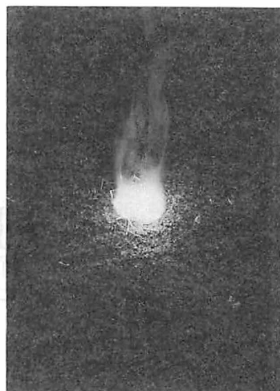
マグネシウム切削屑の燃焼
