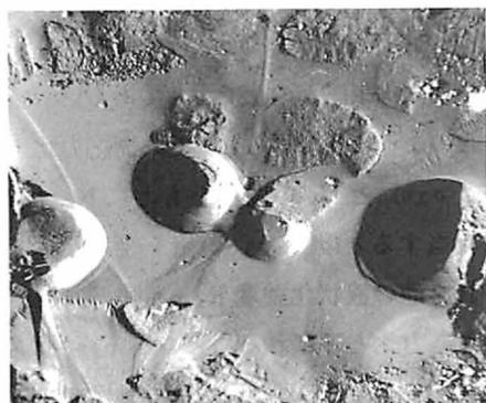
写真-1 千葉県東方沖の地震（63.12.17,  $M=6.7$ ）による千葉港の噴砂
