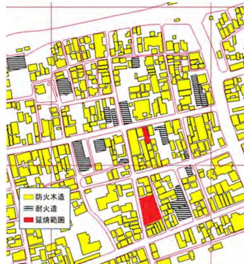
図6 シミュレーション結果(左)と実際の延焼状況(右)の比較(11:35)
