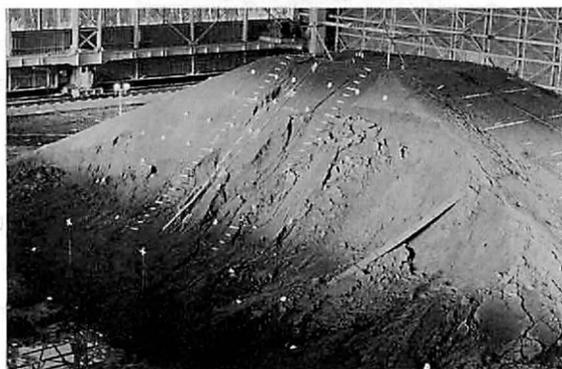
写真—7 40°斜面に発生した崩壊の状況
