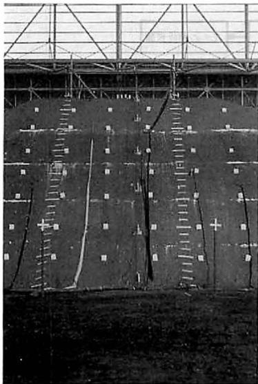
写真一 4 斜面に取付けられた計測器の状況
