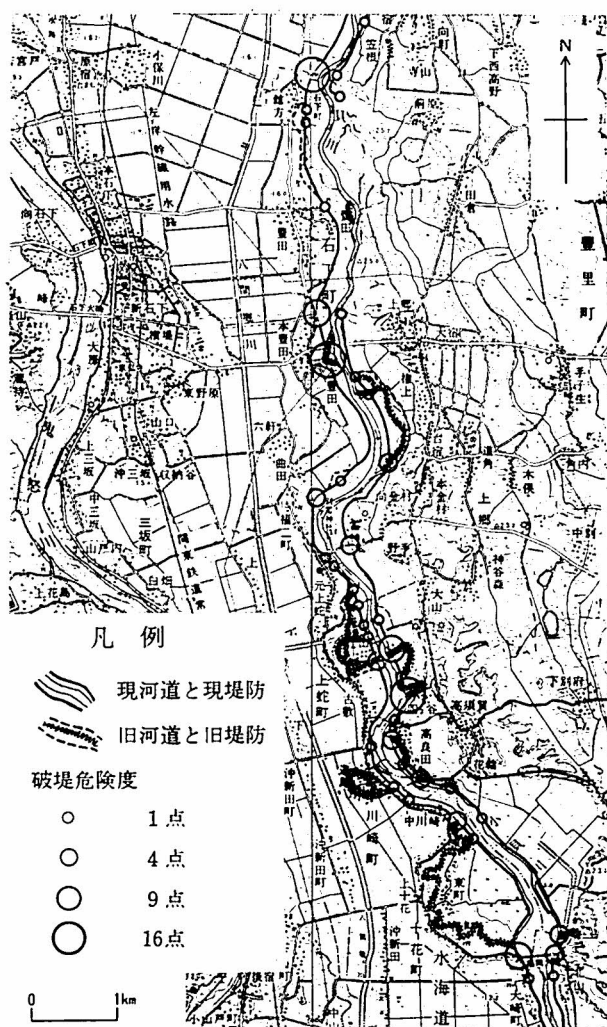
図4 石下町館方付近から福岡壠付近を例とした小貝川破堤防災図の試案 (国土地理院5万分の1地形図「土浦」「水海道」使用)
