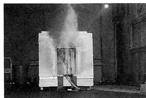
写真5 点火5分後の燃焼状況
