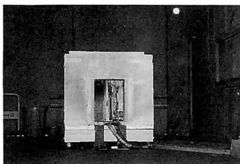
写真4 点火4分後の燃焼状況
