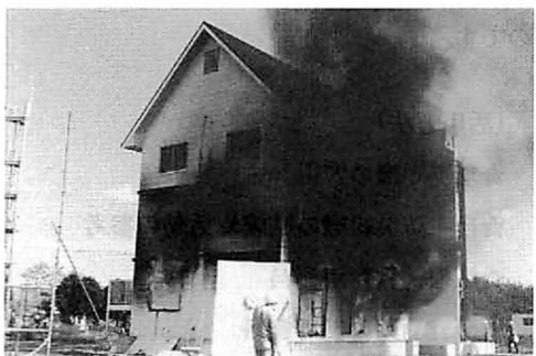
写真3 点火後23分 (南東側居室も火災盛期に入った。)
