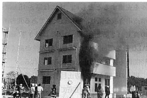
写真1 点火後4分 (1階南居間の開放扉より煙が戸外へ。)
