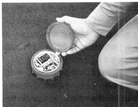
写真 2 装置の蓋兼アダプターを取ったところ（装置内の上側が電池、下側が IC 回路）
