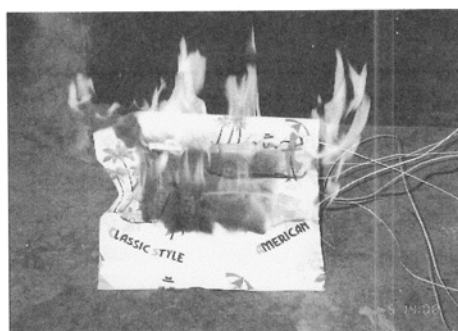
写真1 カーテン2枚の場合の燃焼
