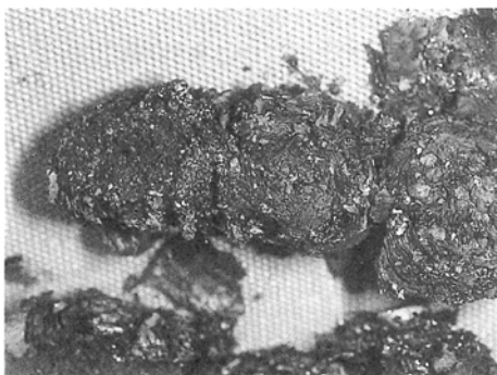
写真5 輪切りにした素子内部の焼損状況
