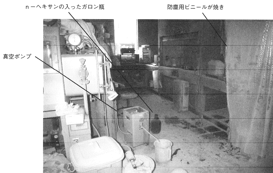
排水処理研究室に置かれた真空ポンプの状況
