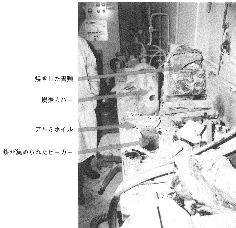
出火箇所付近の状況
