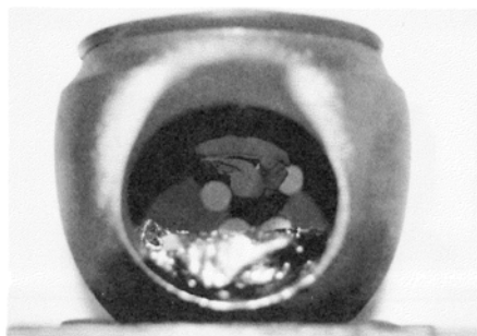
塊状に付着した煤の状況
