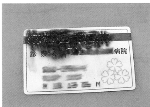
写真4 磁気カードの焼損状況
