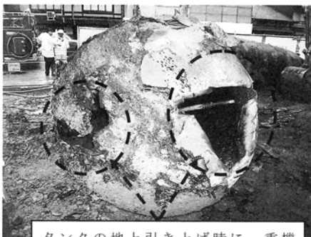
タンクの地上引き上げ時に、重機により開けられた穴(鏡面側)
