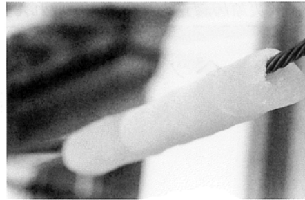
写真2 送電線への着雪(電力中央研究所)
