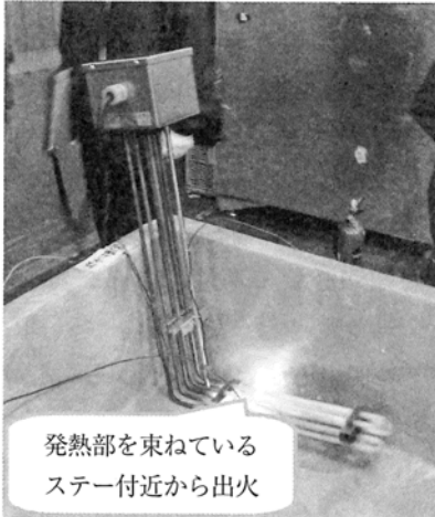
写真6 空焚き時の状況（5分経過時） B庫内の状況
