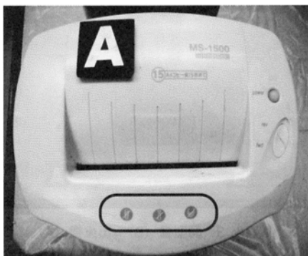
写真No. 4 出火機 (A) 警告表示
