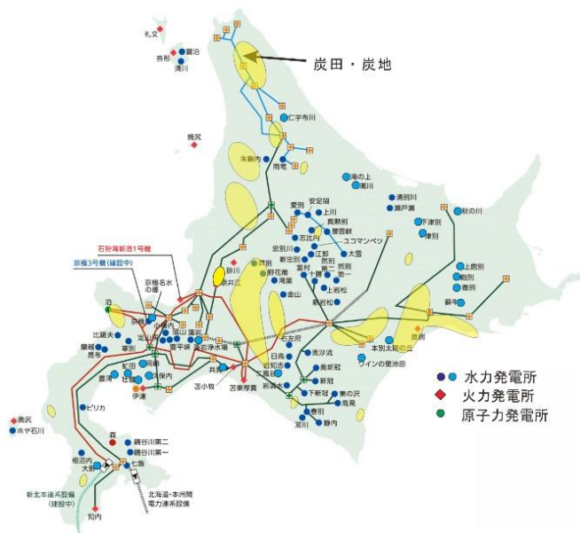
図1 北電電力網と発電所 [2] （○の部分参考文献 [3] をもとに描いた炭田炭地）
