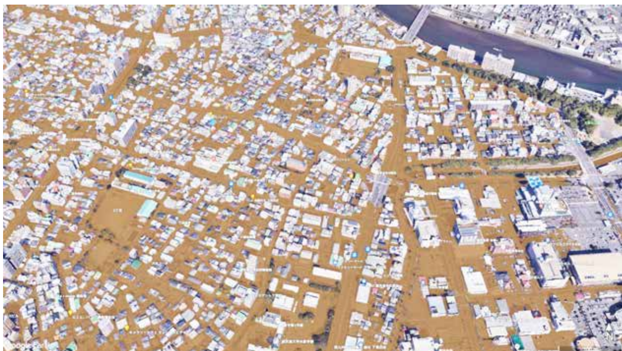
図9 噴火から48時間後の降灰堆積状況の可視化例（2021年8月5日に噴火想定）
