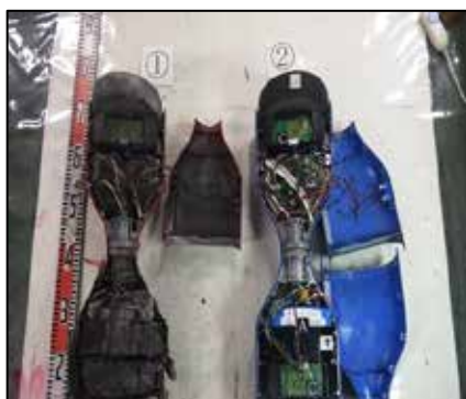
バランススクーターの裏側本体カバーを取り外したもの。
