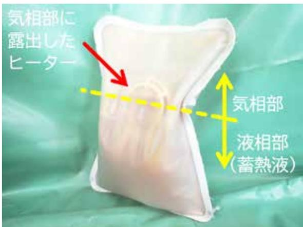
【写真16 気相部に露出したヒーター】
