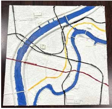
図5 3Dデータ（国土地理院）と3D編集ソフトにより作成された荒川流域の触図（渡辺哲也教授作成）
