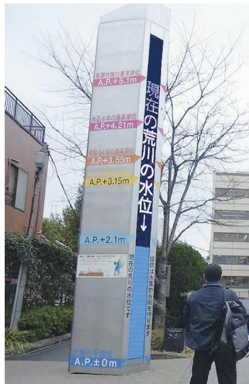
荒川の河川水位をリアルタイムに表示 / 過去の洪水時の荒川の水位を表示（東京都江戸川区役所前）
