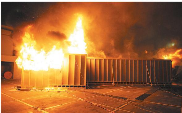
写真26 建屋の燃焼状況
