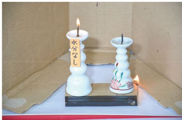
写真8：水分があるローソク（写真右）は火がついたまま芯が落下
