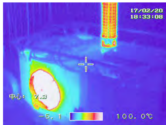
写真5. フィンランド赤十字の熱交換式ジェットヒーター（フィンランド製）、右は熱画像 上部の煙筒からCO 2 を排気し室内に新鮮な暖気を送り込む
