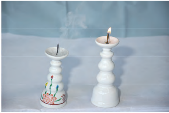
写真11：収去したローソク立て（写真左）で芯が上方に飛び上がった状況
