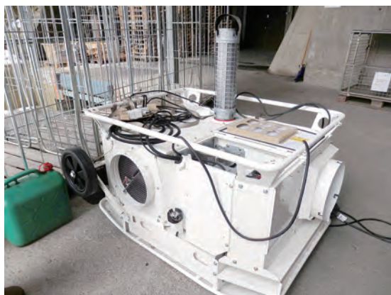
写真5. フィンランド赤十字の熱交換式ジェットヒーター（フィンランド製）、右は熱画像 上部の煙筒からCO 2 を排気し室内に新鮮な暖気を送り込む
