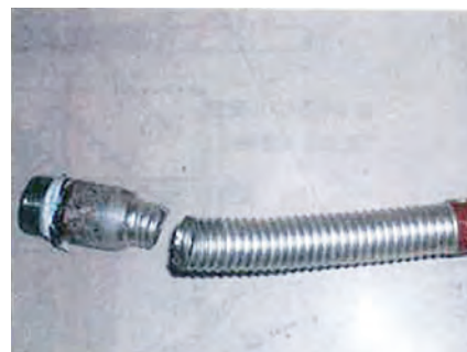
写真 2 : 巻き出し管の損傷事例
