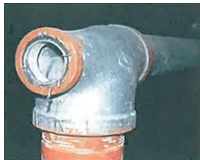
写真1：横引き配管の損傷事例（平成23年（2011年）東北地方太平洋沖地震（東日本大震災）、震度6強地域（気象庁発表））
