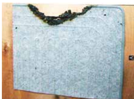
実験 A のカーペットの焼き状況
