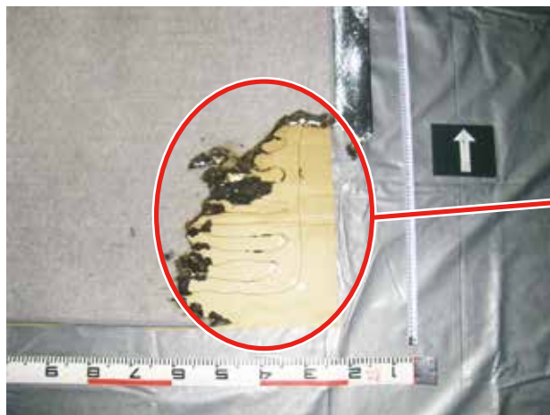
電気カーペットの焼き部分
