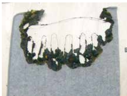
実験 B のカーペットの焼き状況
