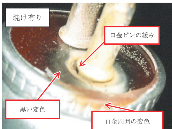
写真10 焼けのあるソケット側の口金
