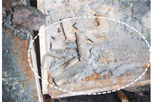
写真3 開口しているリチウムイオン電池
