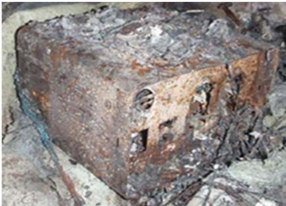
写真18 変圧器（焼損品）
