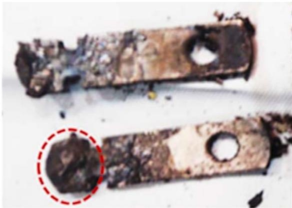
写真17 片刃溶断プラグ
