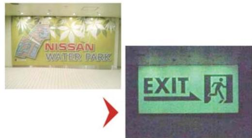
写真 蓄光材を用いた避難誘導表示<sup>1)</sup>より引用
