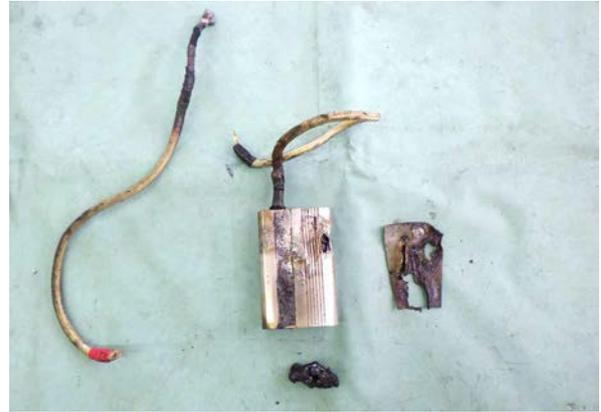
写真9 車両から収去した電圧安定化装置
