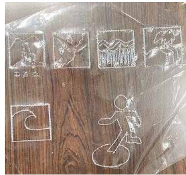
図3 レーザライタにより作成されたピクトグラムの触図
