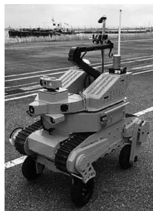
写真2 走行型偵察・監視ロボット一次試作機の概観
