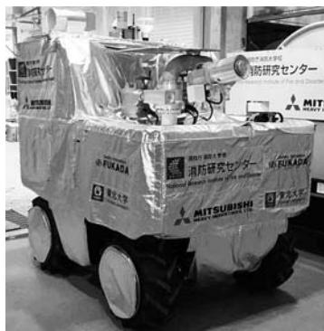
写真3 放水砲ロボット一次試作機の概観
