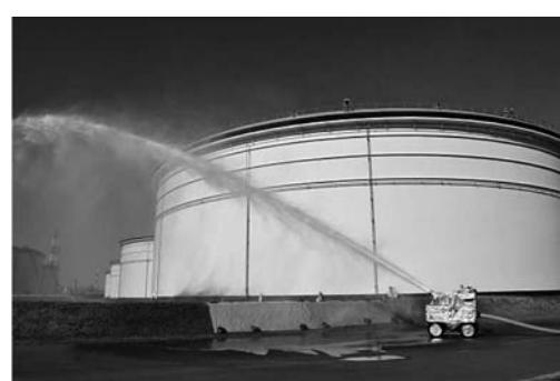
放水砲ロボットによる放水状況
