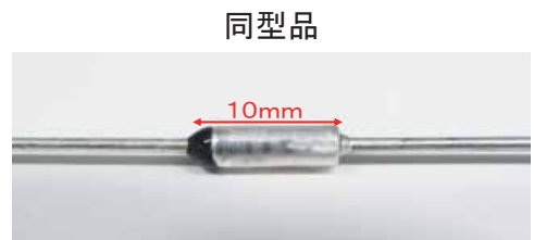
同型品は公称作動温度109℃、定格電流15アンペア 写真9 焼損した温度ヒューズ
