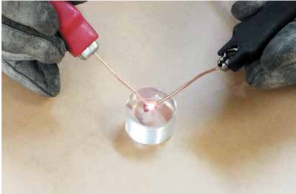
溶融した温度ヒューズの一部を露出させた状態で樹脂に埋め込んでいる
